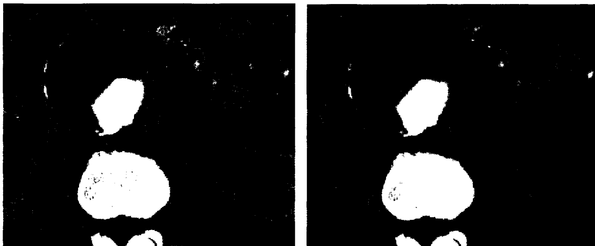
Figure 57 Filtre de diffusion non linéaire par schéma d'optimisation AOS À gauche image originale, à droite, image après filtre
