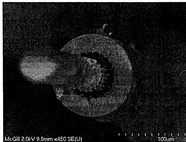
Figure 57 Surface de clive de l'échantillon #2. Les ponts sont détruits sous une contrainte élevée.
