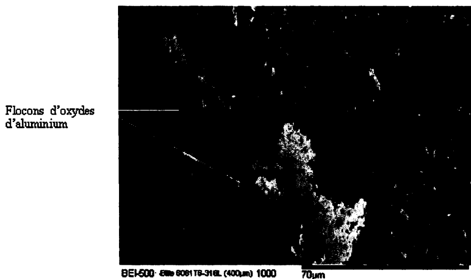
Figure 86 Agglomération de particules d'oxyde d'aluminium (zone IV)
