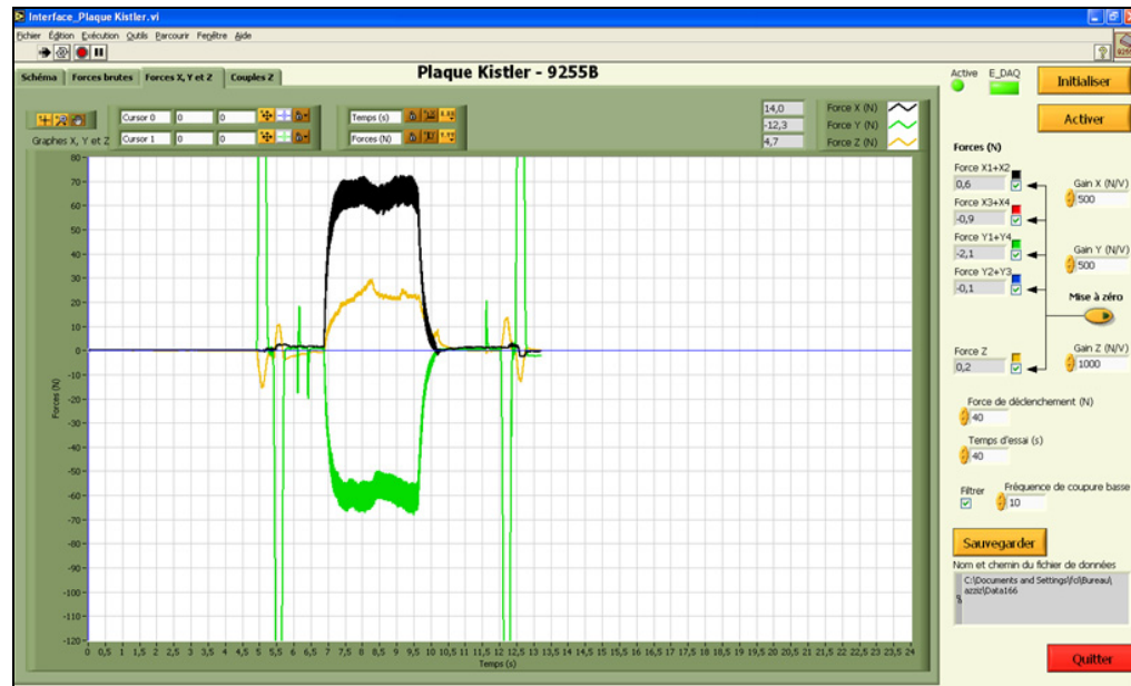
Figure 3.5 Interface de plaque Kistler-9255B pour la mesure des forces. ÉTS (2009)
