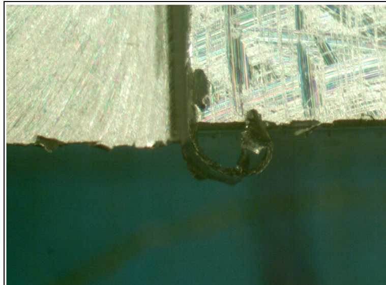
Figure 4.3 Formation des bavures roulées en ED.
