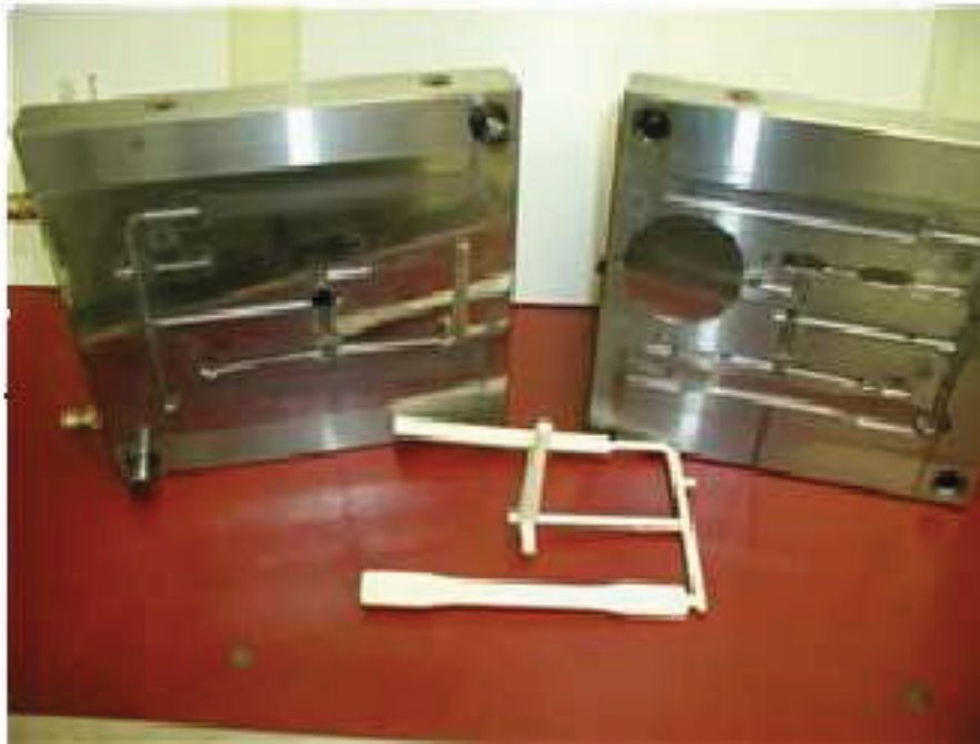
Figure 5.6 Moule pour l'injection des éprouvettes standardisées. Tirée du site Internet de l'IMI
