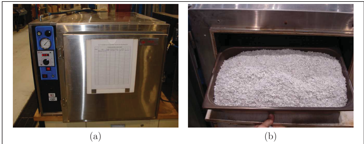
Figure 5.4 Séchage à l'étuve. (a) Étuve et (b) matière granulée.
