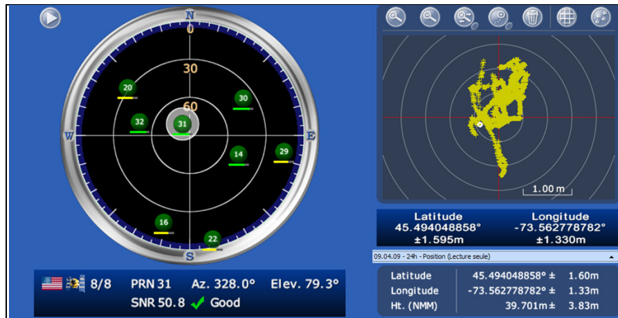
Figure 6.11 Test de validation : Satellites visibles et erreur relative sur la position du récepteur NovAtel au début du test.
