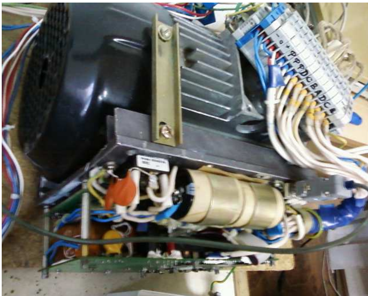
Рис. 5.18 – Внешний вид разработанного КУ ВРД в составе ЭМП без защитного кожуха (вид сверху слева: плата ПУ расположена над платой КЗТ)
