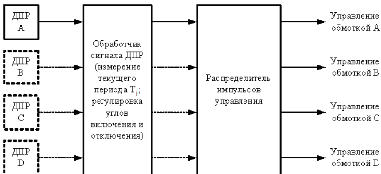
Рис. 5.3 – Обобщенная структурная схема узла формирования циклограммы управления обмотками
