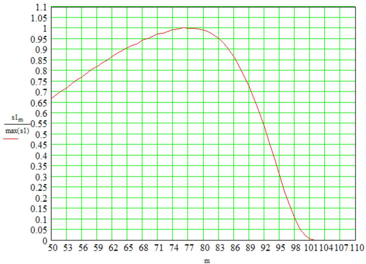
Рис. П.1. График зависимости критериальной величины от внутреннего диаметра статора
