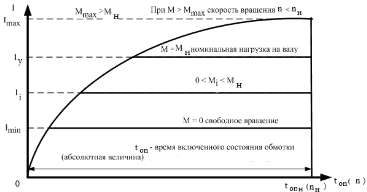
Рис. 5.8 – Зависимость величин уставок тока в обмотках при различных нагрузочных моментах на валу с замкнутой ОС по частоте вращения ротора (то есть n = \text{const} , а уставка по току обмоток I – автоматически регулируемая величина I = 0 \dots I_{\text{max}} ), при этом длительность включённого состояния обмоток постоянна
