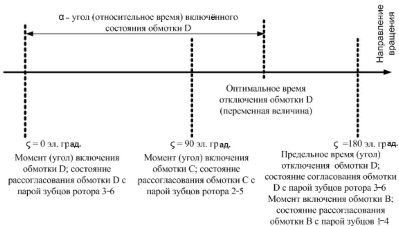
Рис. 5.1 – Иллюстрация состояния рассогласования (0 эл. град.) обмотки D и пары зубцов ротора 3 – 6 и состояния согласования (180 эл. град.) обмотки D и пары зубцов ротора 3 – 6 в линейных координатах
