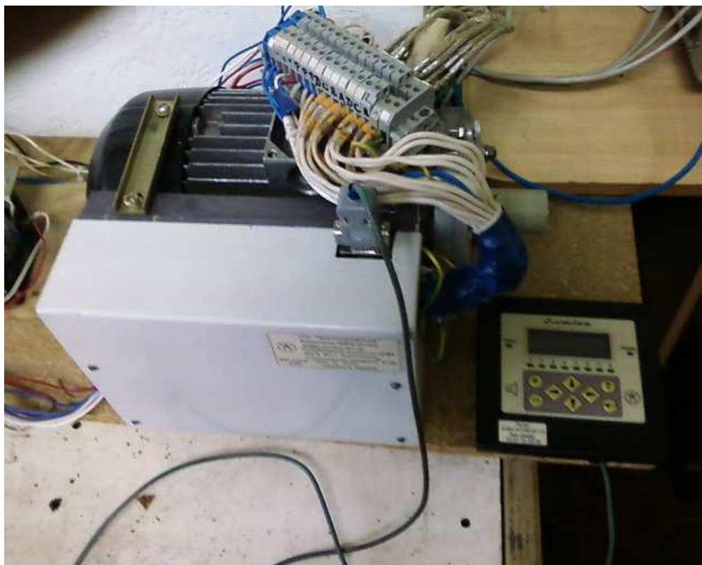
Рис. 5.19 – Внешний вид разработанного КУ ВРД в составе ЭМП с пультом настройки ПН
