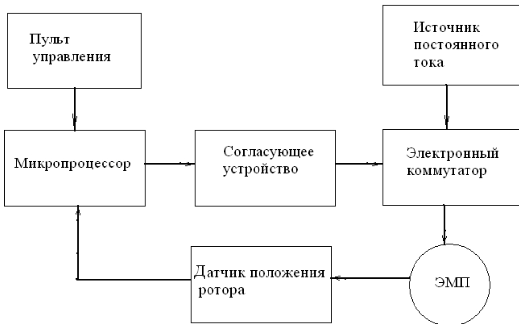
Рис. 1.1 – Электромеханическая система, преобразующая электрическую энергию в механическую
