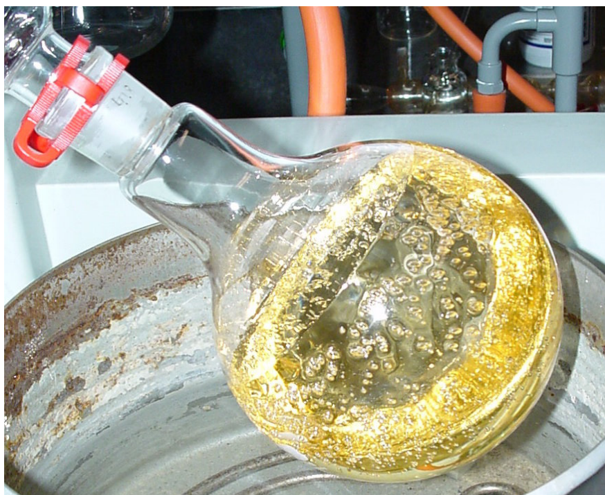
Kuva 2.2.3. 1-allyyli-3-metyyli-imidatsoliumkloridia kuivamassa pyöryhaiduttimessa synteessin jäljiltä. Voimakkaan keltainen väri johtuu lähtöainejäämistä.
