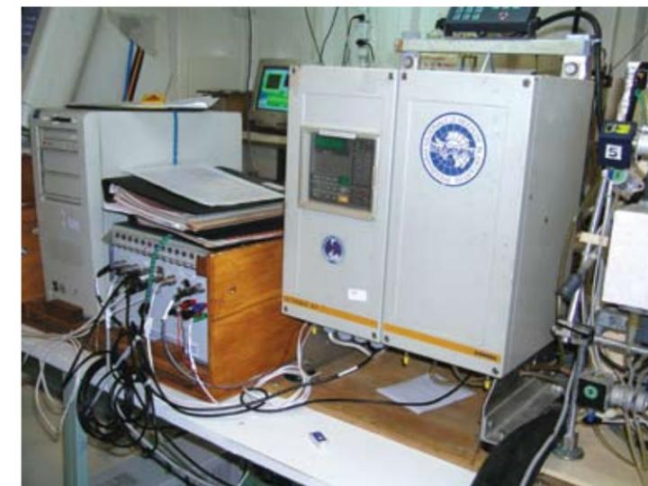
Figura 5. Sistema de medición de las presiones parciales de CO<sub>2</sub> en el agua de mar y en la atmósfera.
