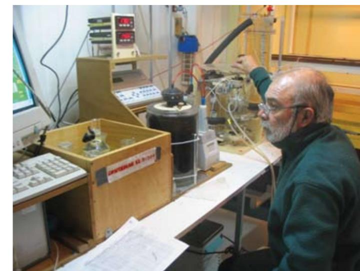
Figura 6. Un integrante del grupo de trabajo realizando determinaciones de alcalinidad y contenido total de CO<sub>2</sub> en muestras de agua. El sistema puede realizar las mismas en forma automática durante la navegación de la superficie de mar, pero permite también su utilización para el análisis de laboratorio.
