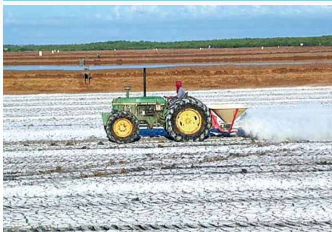
Figura 31c. Encalado mecánico de un estanque camaronero, como parte de su preparación antes de la siembra. El uso de un equipo especializado permite aplicar la cal sobre el suelo de manera uniforme, en menos tiempo y con mayor seguridad para los trabajadores. Foto cortesía del Ing. C. Lara.
