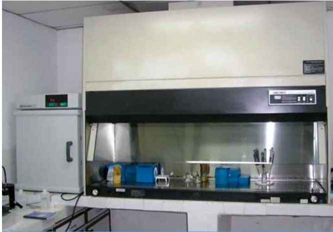
Figura 56a. Incubadora con temperatura controlada (izquierda) y cabina de flujo laminar Clase II, utilizadas para estudios de bacteriología en el laboratorio de una granja camaronera. Foto cortesía del Dr. J. Cuéllar-Anjel.
