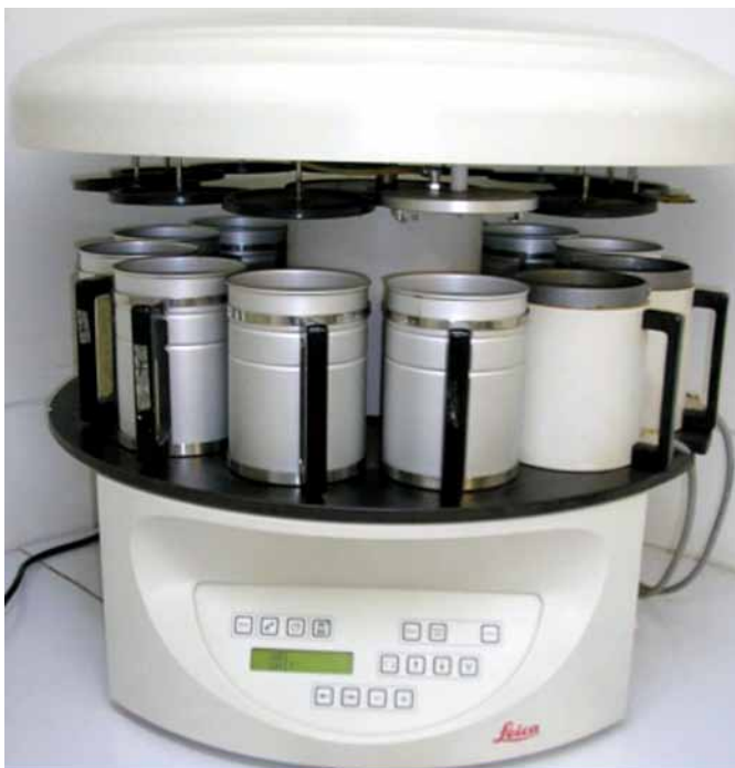
Figura 56b. Equipo para procesamiento de tejidos, utilizado en la preparación de láminas histológicas para el estudio de órganos y tejidos de camarones sospechosos de una enfermedad. Foto cortesía del Dr. J. Cuéllar-Anjel.
