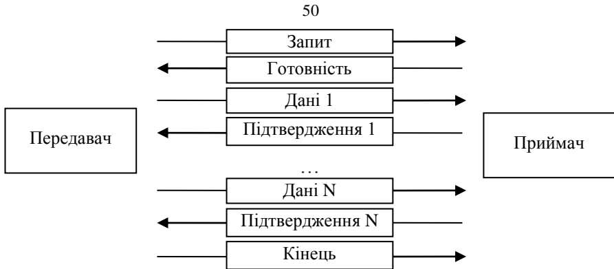
Рис. 32. Приклад обміну пакетами під час сеансу зв'язку
