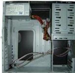
2. Pasanglah mur dengan obeng untuk penyangga motherboard yang akan dipasang. Pasanglah pada lubang-lubang bawaan yang sudah ada di dalam casing komputer.
