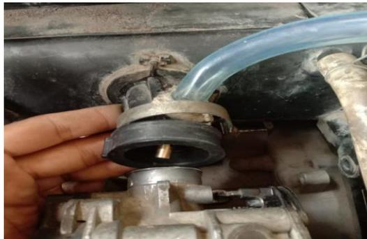
*Gambar 6.5 pelepasan filter & nozle*
