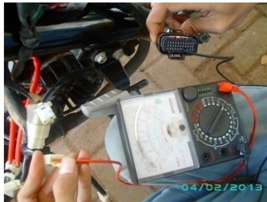
*Gambar 5.0 Memeriksa hubungan kabel hitam/biru antara connector crankshaft position sensor dan connector ECU*
