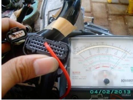
*Gambar 4.5 Memeriksa hubungan kabel kuning antara connector throttle position sensor dan connector ECU(Sumber : Dokumentasi kami)*
