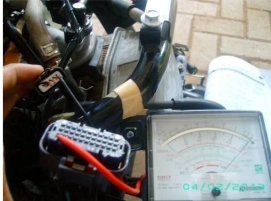
*Gambar 3.9 Memeriksa hubungan kabel coklat/putih antara connector intake air temperature sensor dan connector ECU(Sumber : Dokumentasi kami)*
