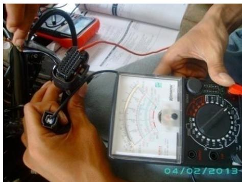
*Gambar 3.1 Memeriksa hubungan kabel orange/hitam antara connector fuel injector dan connector ECU (Sumber : Dokumentasi kami)*
