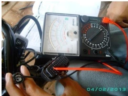
*Gambar 5.2 Memeriksa hubungan kabel hitam/biru antara connector engine temperature sensor dan connector ECU(Sumber : Dokumentasi kami)*
