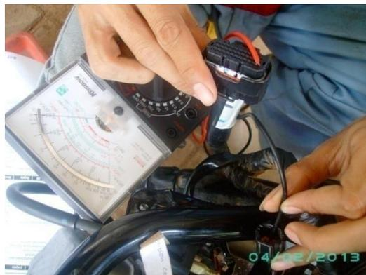
*Gambar 5.1 Memeriksa hubungan kabel abu-abu/merah antara connector O2 sensor dan connector ECU(Sumber : Dokumentasi kami)*
