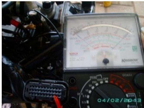
*Gambar 3.3 Memeriksa hubungan kabel merah muda antara connector idle speed control dan ECU(Sumber : Dokumentasi kami)*
