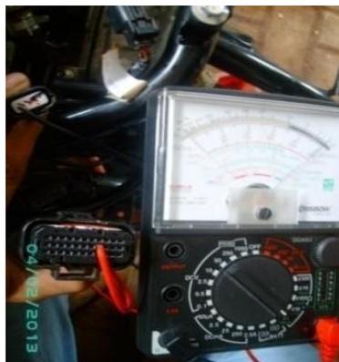
*Gambar 3.5 Memeriksa hubungan kabel abu-abu antara connector idle speed control dan connector ECU(Sumber : Dokumentasi kami)*
