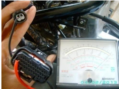
*Gambar 5.3 Memeriksa hubungan kabel hijau/merah antara connector engine temperature sensor dan connector ECU(Sumber : Dokumentasi kami)*
