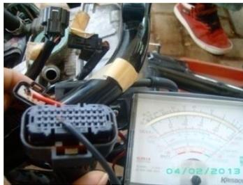
*Gambar 4.3 Memeriksa hubungan kabel biru antara connector intake air pressure sensor dan connector ECU(Sumber : Dokumentasi kami)*
