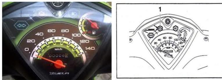
*Gambar 2.7 Lampu indikator mesin bermasalah (Service Manual Yamaha MIO J, 2012:6-3)*
