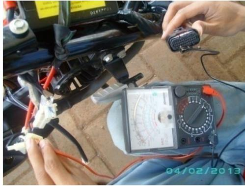
*Gambar 4.9 Memeriksa hubungan kabel putih/merah antara connector crankshaft position sensor dan connector ECU(Sumber : Dokumentasi kami)*
