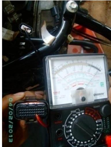
Gambar 3.6 Memeriksa hubungan kabel biru muda antara connector idle speed control dan connector ECU(Sumber : Dokumentasi kami)
