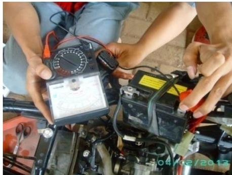
*Gambar 3.2 Memeriksa hubungan kabel merah antara battery dan connector ECU(Sumber : Dokumentasi kami)*
