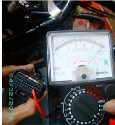
*Gambar 3.4 Memeriksa hubungan kabel hijau/kuning antara connector idle speed control dan connector ECU(Sumber : Dokumentasi kami)*
