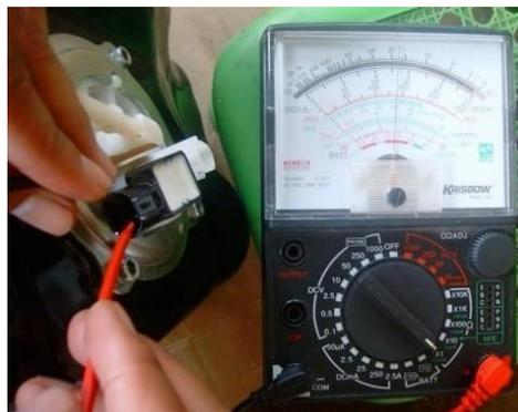
Gambar 3.0 Pengukuran Tahanan Pompa Bahan Bakar
