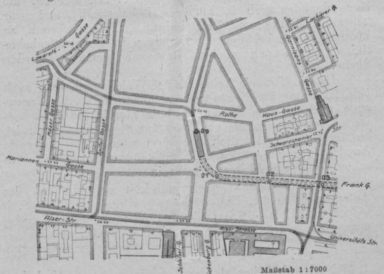
Abb. 36 Entwurf eines Verbauplanes für die Gründe des Allgemeinen Krankenhauses und der Alserkaserne sowie der dort geplanten Tunnelrampe
