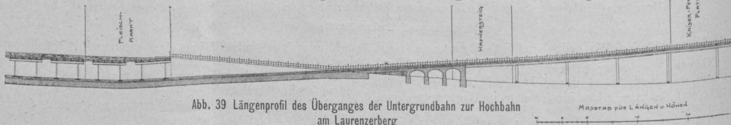
Abb. 39 Längenprofil des Überganges der Untergrundbahn zur Hochbahn am Laurenzerberg
