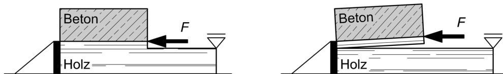
Abb. 4-7: Krafteinleitung in Höhe der Kontaktfuge Holz-Beton
