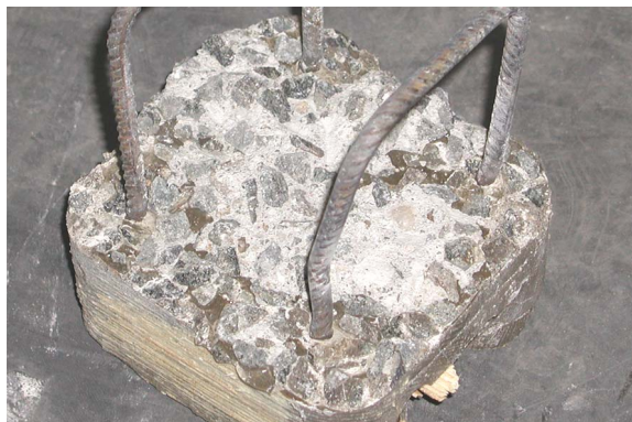
Abb. 4-14: Freigelegte Polymerbetonnocke nach Beendigung des Versuches
