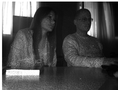
Slika 3. IR slika sa Kinect senzora
