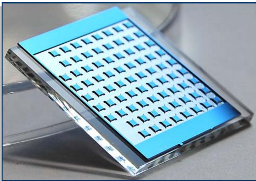
Четвртка са подлошкама спојена са PYREX стаклом технологијом анодног бондовања
