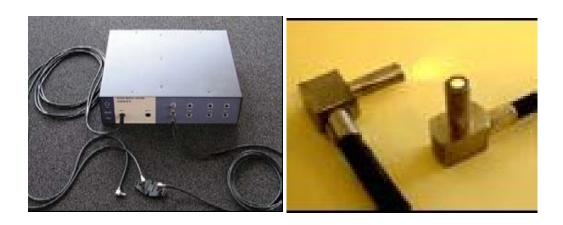
Figura 2. Spettroscopio a raggi infrarossi Oxymon MK III e diodi laser.
