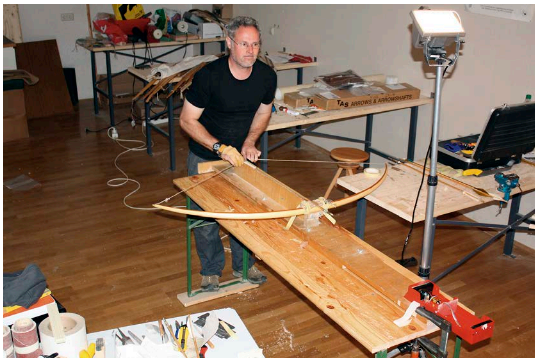
Abb. 275: Lenk, Schnidejoch. Nachbauten des Bogens 2003. Geschwindigkeitsmessungen mit Nachbau 3 des Schnidejochbogens (Messgerät «Shooting Chrony Alpha»).
