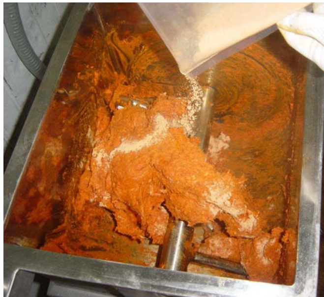
Figura 3.3. Amasado de los ingredientes de la sobrasada al incorporar el ingrediente funcional.
