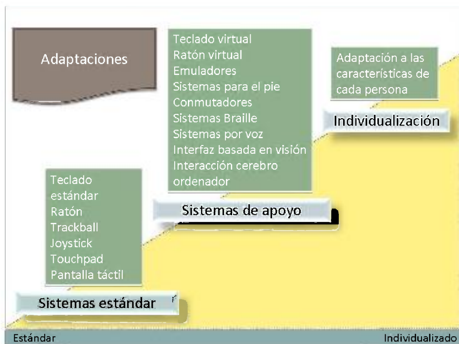
Figura 2-1. Clasificación de dispositivos de entrada de datos según su estandarización (diseño para una población general o estándar) o su individualización.)
