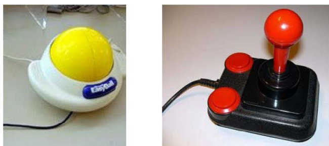
Figura 2-2. Trackball (izquierda) y joystick (derecha).
