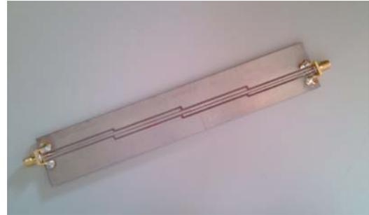
Fig. 6 Placa fabricada del filtro pasabanda.
