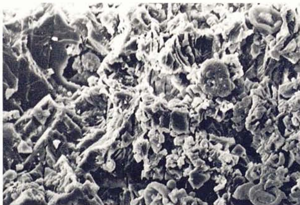
Figura 5: a) Fotografies al microscopi electrònic on s'observa l'increment de superfície deguda a l'acció biològica (RK). Escales gràfiques: 100µm i 20µm. b) Detall de la superfície polida a la mostra RP, on s'observa una certa irregularitat que pot ser l'origen d'una petita quantitat de carbonats particulats. Escales gràfiques: 100µm i 10µm.
