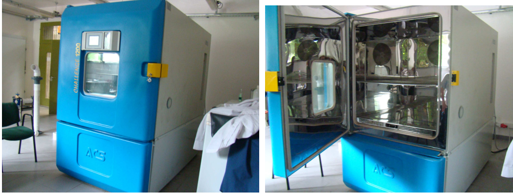
Figura 7: Cámara de climática Angelantoni
