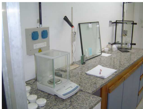
Figura 10: Balanza utilizada para medir las masas de desecante y el vapor de agua capturado
