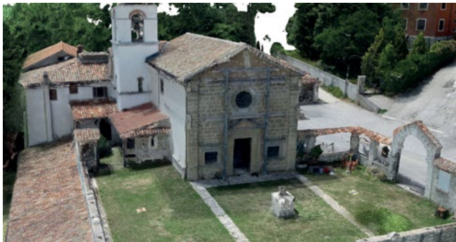
Figura 10. Una vista a volo d'uccello della nuvola di punti da volo UAV.
