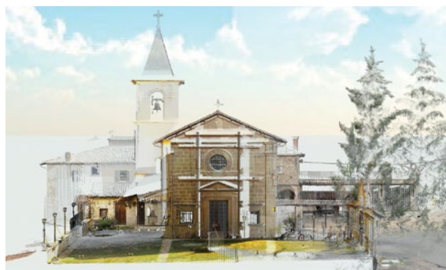
Figura 7. Visualizzazione della nuvola di punti esterna.
