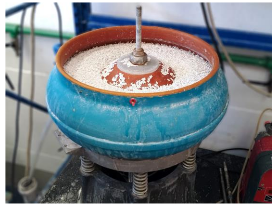
Fig. 1. AV 40 vibro-finishing machine (Best Finishing Srl, Italy).
