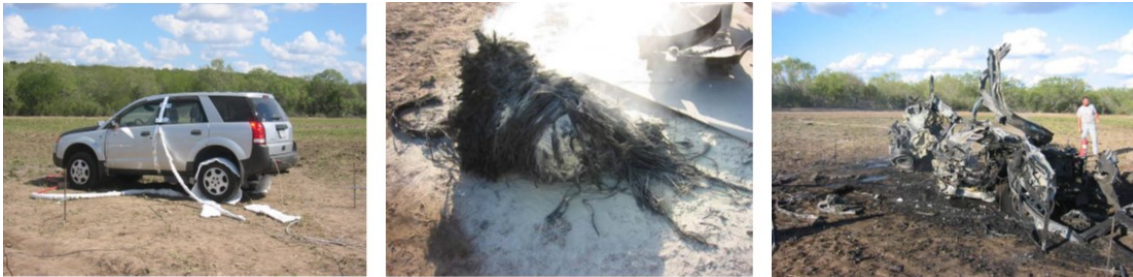
Abbildung 1.1.: Brandversuch eines SUVs mit integriertem Wasserstofftank [84], [86].
