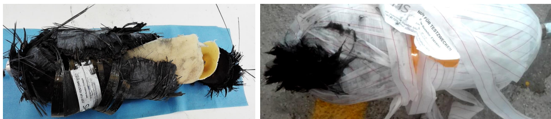
Abbildung 5.22.: Versagensbild bei Berstversuchen eines Tanks mit Harz (links) und ohne Harz (rechts).
