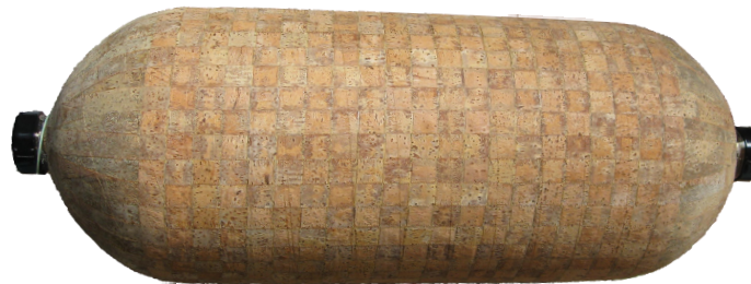
Abbildung 6.24.: Tankprototyp mit Kork für Brandversuche.
