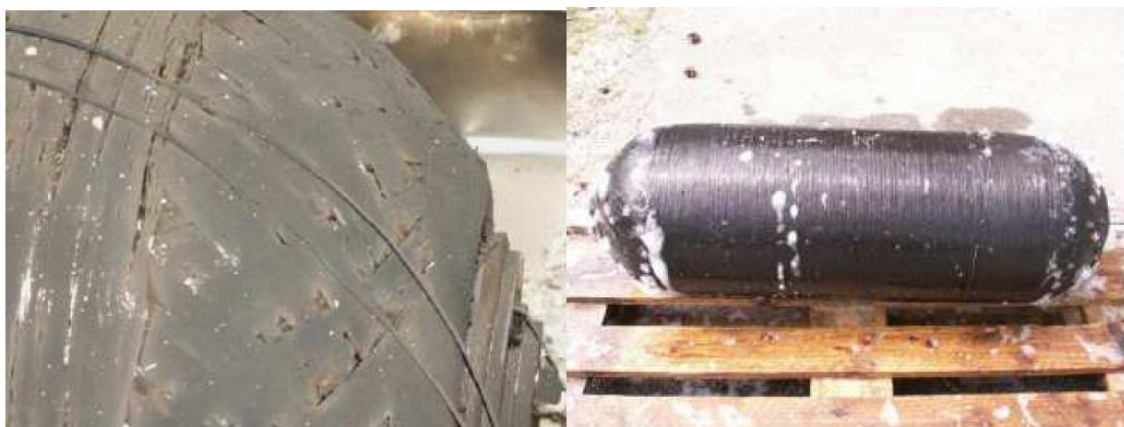
Abbildung 3.4.: Tankzustand nach Entlastung des Tanks durch Leckagebildung [64].
