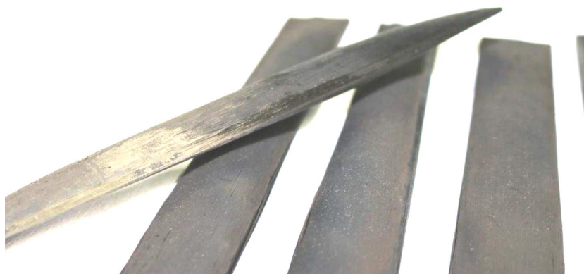
Abbildung 5.16.: Verkohlte Plattenproben nach einer Temperaturbelastung von 400 °C für 2,5 Minuten.
