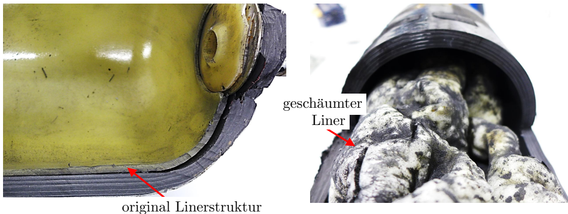
Abbildung 5.26.: Strukturveränderungen des Liners aufgrund einer Temperaturbelastung von über 330 °C auf der Tankunterseite.
