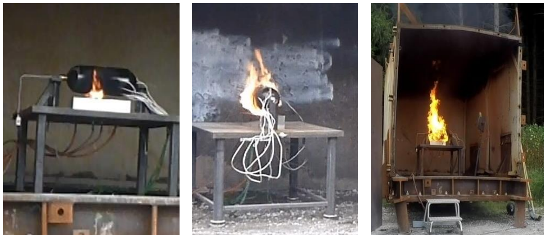
Abbildung 5.39.: Brandversuche mit Feuerbelastungsflächen von 10, 50 und 100 % der zylindrischen Tankoberfläche.
