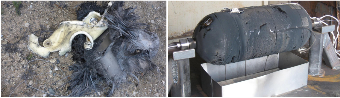
Abbildung 5.45.: Tankzustand nach den Brandversuchen mit Initialdrücken von 400 bar (links) sowie 200 bar (rechts) und niedrigem Wärmestrom.
