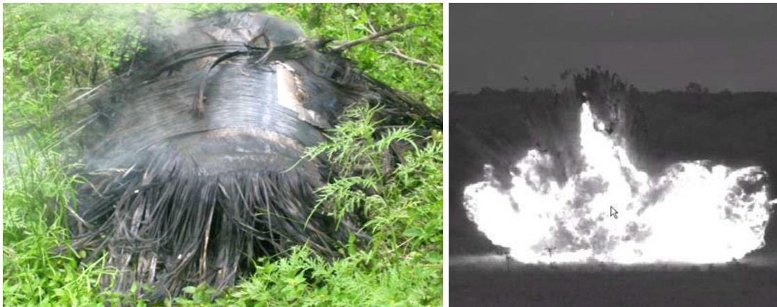
Abbildung 3.3.: Links: Tankfragment nach Behälterbersten. Rechts: Feuerball verursacht durch Behälterbersten [88].
