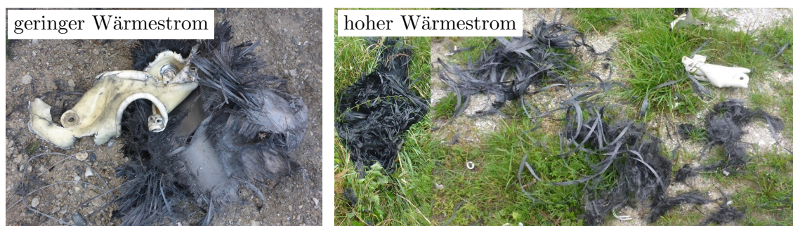
Abbildung 5.33.: Tankfragmente nach Behälterbersten bei der Unterfeuerung von Wasserstofftanks mit unterschiedlichen Wärmeströmen.
