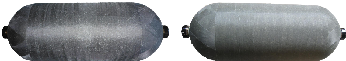
Abbildung 6.22.: Tankprototyp mit den Brandschutzmatten T6663-00 (links) und 60851A (rechts) für Brandversuche.
