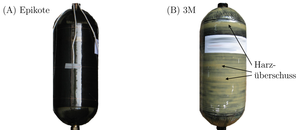
Abbildung 6.9.: Vergleich der Oberflächenbeschaffenheit von Tanks, gefertigt mit T700-Fasern und Epikote-Harz (A) beziehungsweise 3M-Nanopartikelharz (B).
