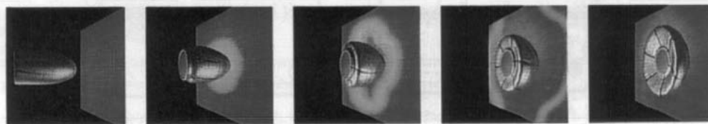
Слика 2: Рачунарска симулација процеса пробијања циља зрном (Станојевић, 2010)
