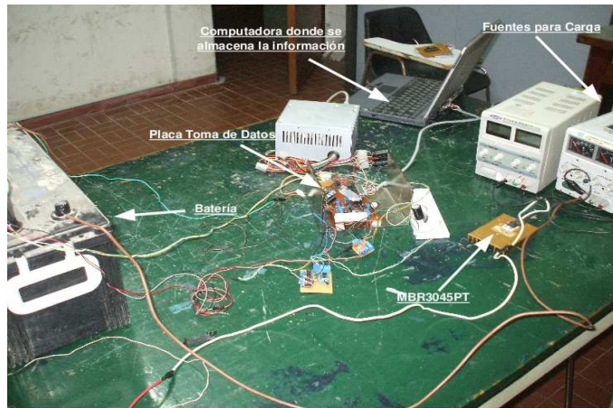
Figura 4. Ensayo de carga de una batería de plomo ácido.
