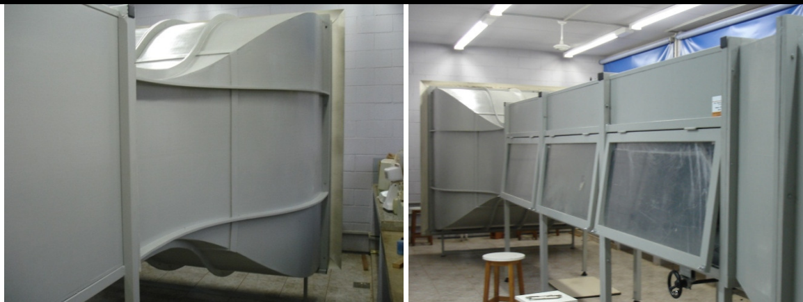
(a) (b) Figura 2: (a) Detalhe da contração do bocal na entrada do túnel de vento; b) Lateral do túnel de vento, vista do lado das portas de acrílico da seção de ensaio.
