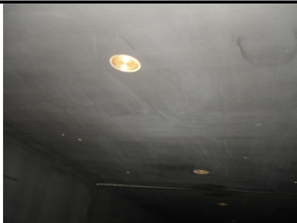
Figura 5: Disco com um furo central fixado no teto da seção de ensaio do túnel, para a medida da pressão estática.
