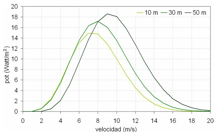
Figura 8: Variación de la densidad de potencia en función de la velocidad a 10, 30 y 50 m de altura sobre el nivel del suelo.
