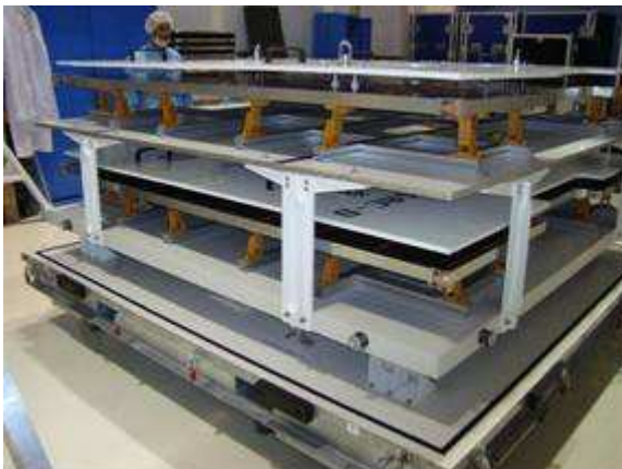
Figura 6: Contenedor de transporte con los paneles solares del SAC-D (izquierda) y cerrado (derecha).
