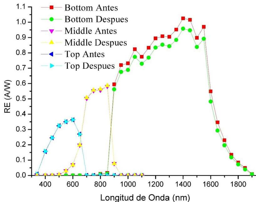
Figura 7: RE de una celda ATJ antes y después de su irradiación con protones. Esta RE fue medida utilizando el nuevo patrón "Ref ATJ Vuelo".
