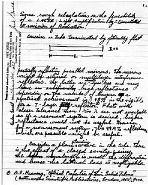
La propuesta, con base en un segundo resultado teórico fundamental ya detallado, dice que el resonador abierto, formado por los dos espejos, genera el aumento de radiación dentro del medio activo, tal como lo requería la última expresión matemática mencionada en párrafos anteriores.
