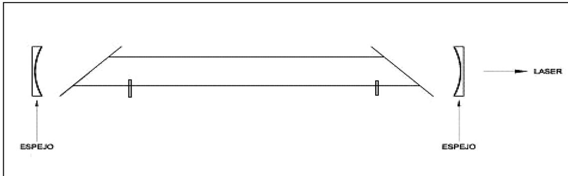
Esto significa, **radiación de luz altamente monocromática, direccional, coherente (todas las ondas viajan en fase) y de gran intensidad.**
