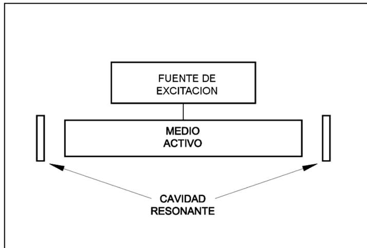
El láser que se va a utilizar como ejemplo, es gaseoso y se compone de un tubo de vidrio de, aproximadamente 0,005 m de diámetro y 1,3 m de longitud, lleno de gas a baja presión y tal como muestra la figura (esquema fuera de escala), con electrodos y ventanas en sus extremos orientadas según el ángulo de Brewster.
