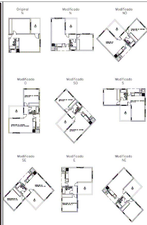
Fig. 5: Adaptaciones de la tipología optimizada según la orientación para mejorar ventilación y asealamiento
