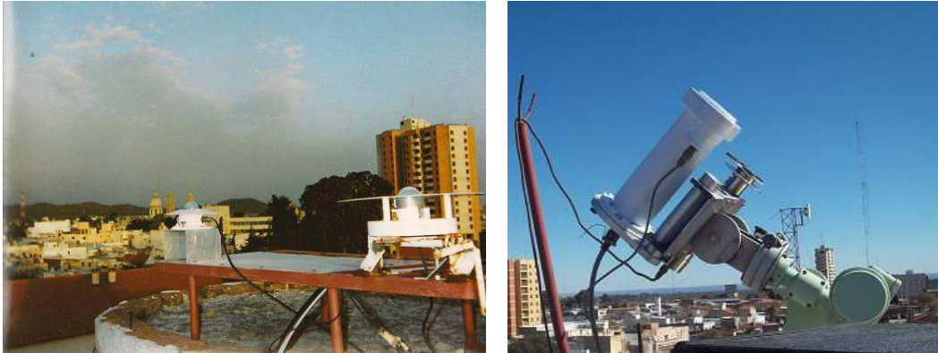
Figura 1. Vista de los sensores utilizados (piranómetros, izquierda, y pirheliómetro de incidencia normal, derecha) y su ubicación sobre el techo del Laboratorio de Energía Solar en la ciudad de San Luis.
