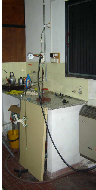
Figura 2. Dispositivo para hacer vacío y cargar el tubo.
