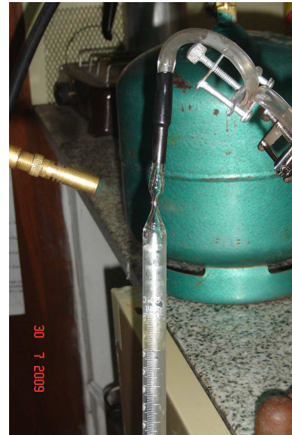
Figura 3. Detalle del sellado con fuego una vez que el tubo fue cargado.
