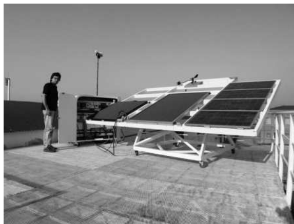
Figura 7: Colocación de termocuplas para ensayo de colector en vacío
