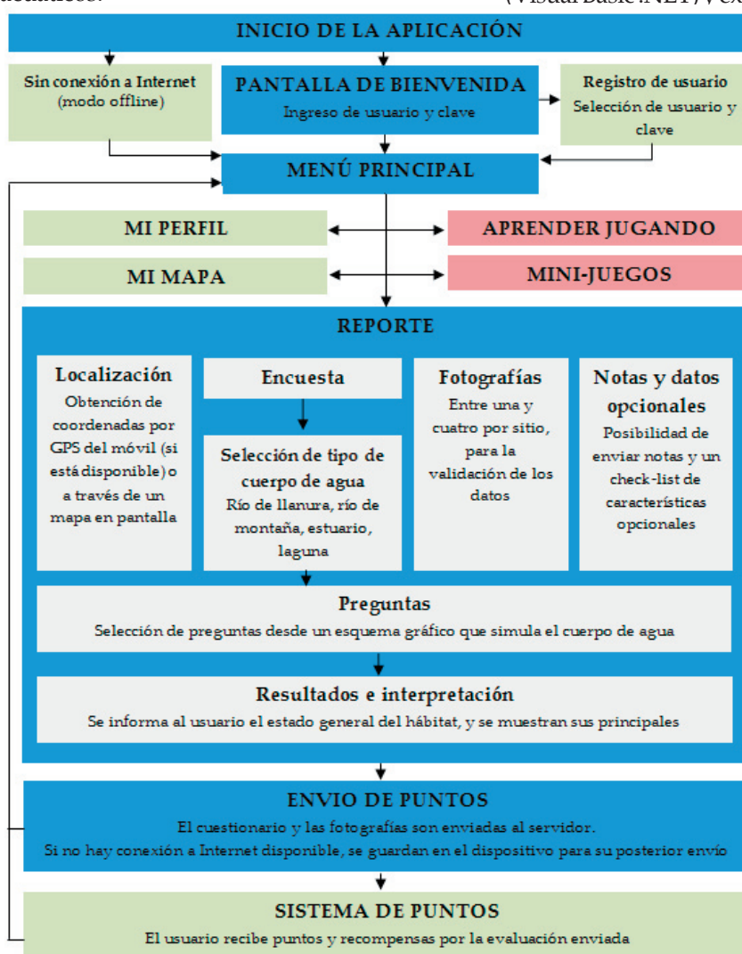
Figura 1. Diagrama de bloques del funcionamiento de la aplicación móvil APPEAR. Los bloques en azul indican la trayectoria desde el inicio de la aplicación hasta el envío de un reporte completo. Los bloques de color rojo demarcan las características educativas de la aplicación, mientras que los de color verde indican las funciones accesorias al funcionamiento.
