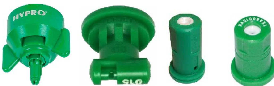
Figura 1. Vista lateral de las boquillas bajo estudio. De izquierda a derecha: boquilla abanico plano inducida por aire (GA); boquilla Turbo Teejet (TT); boquilla cono hueco inducido por aire (AITX); boquilla cono hueco convencional (TXA).
