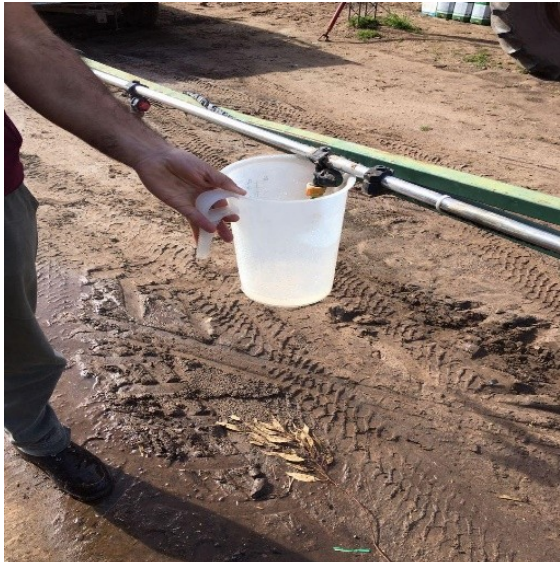
Foto N°2. Control de caudal de trabajo con jarra graduada.
