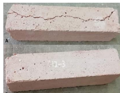
Hormigones calcinados a 800°C con dolomita de mayor (A) y menor (B) tamaño de partícula.
