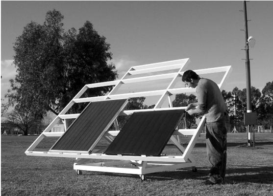
Figura 7: Estructura del banco de ensayos en perfilera de hierro tubo rectangular, UTN-FRBA
