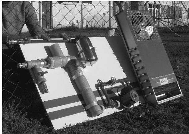
Figura 10: Cuadro hidráulico con enfriador de agua por aire forzado, UTN-FRBA
