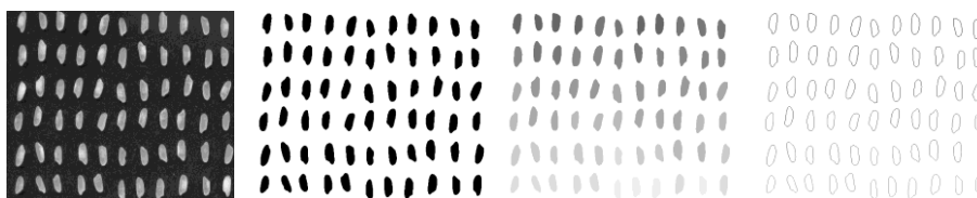
FIGURA 1: Imagen original. Imagen binarizada. Imagen con los granos identificados por nivel de gris
