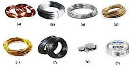
Gambar 4. Bahan-Bahan Konduktor (a) tembaga, (b) besi, (c) aluminium, (d) kuningan, (e) emas, (f) baja, (g) raksa/mercury, dan (h) perak. (Sumber: http://elkatechno.blogspot.com )
