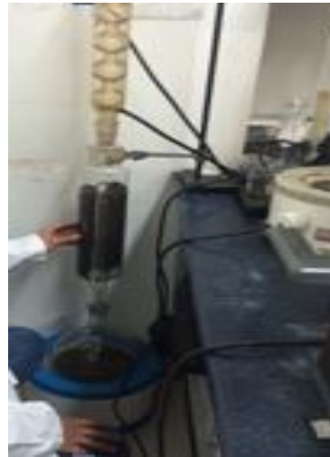
Imagen 11. Equipo Soxhlet para la extracción de las hojas D. phylloides (Kunth) Wedd (Fuente: Autor).
