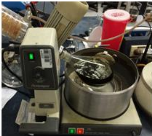
Imagen 12. Rotaevaporador donde se concentran los diferentes extractos de las hojas D. phylloides (Kunth) Wedd (Fuente: Autor).
