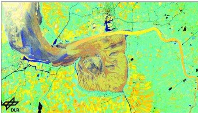
Bild 5.8: Relativer Schwebstoffgehalt in der Ems: je gelber, um so mehr Schwebstoff ist oberflächennah im Wasserkörper vorhanden. Satellitenaufnahme (Spot 5) vom 30. Juli 2002 10:29 UTC (Quelle: DLR)
