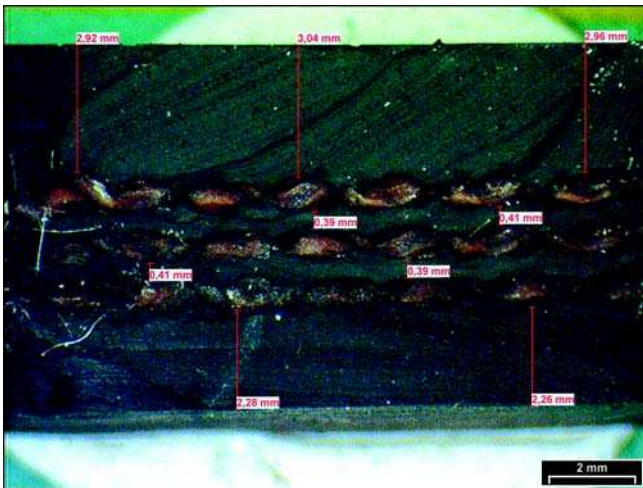
Bild 7.12: Mikroskopische Aufnahme eines Querschnitts einer Schlauchmembran
