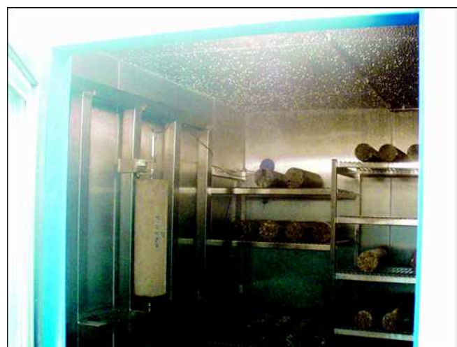
Bild 7.3: Nebelkammer im Baustofflabor, Balken im Dehnungsmessstand
