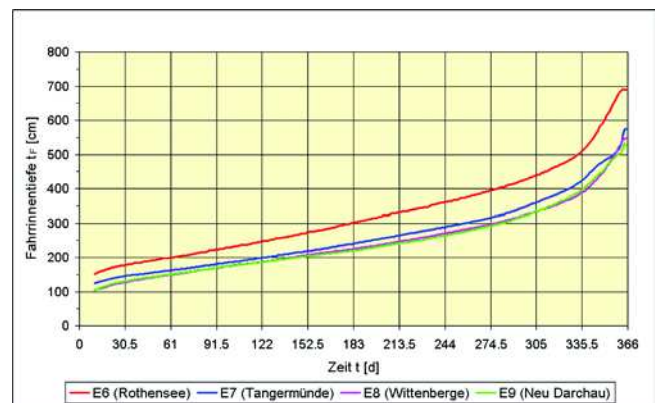
Bild 4.8: Vergleich der Fahrrinntiefendauerlinien der Strecken E6 bis E9
