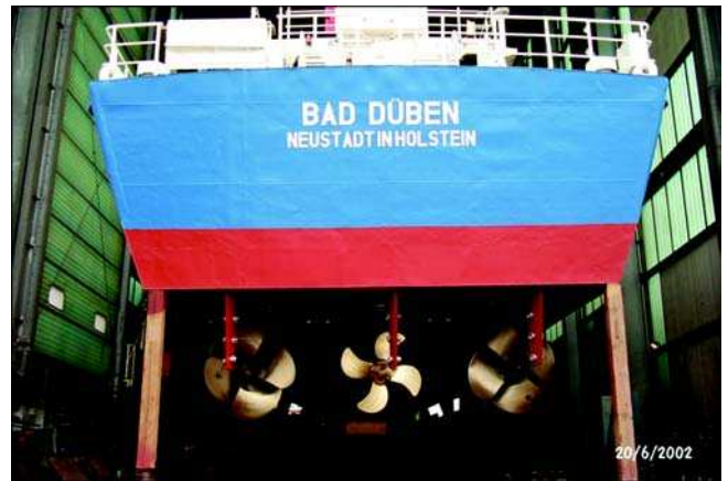
Bild 5.18: BAD DÜBEN (BG 23), Antriebswellen mit nachgerüstetem Sparantrieb (Mitte)
