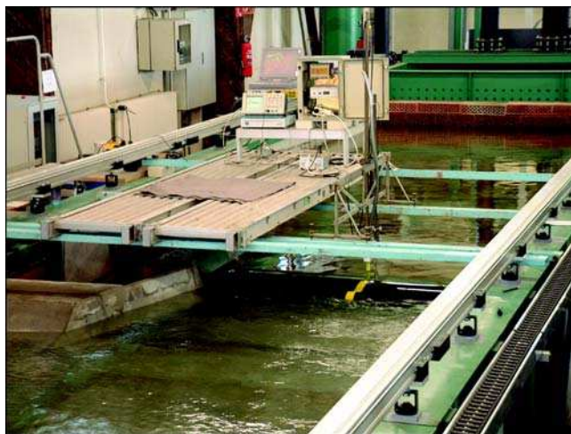
Bild 7.11: Schwingungsuntersuchungen am Vollmodell, Maßstab M 1:12,5
