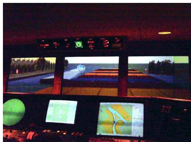
Bild 4.17: Begegnung binnengängiges Seeschiff mit einem 185 m langen Schubverband im Fahrsimulator Warnemünde
