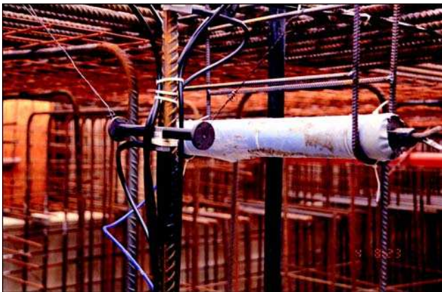
Bild 7.1: Dehnungsaufnehmer (vorne) und Spannungsaufnehmer
