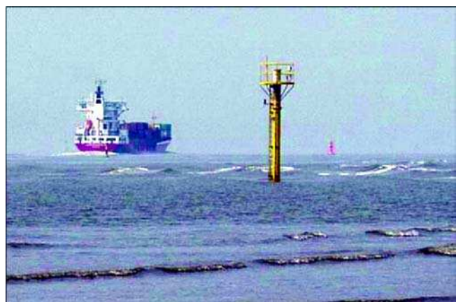
Bild 5.2: Schiffserzeugte Wellen eines großen Feeder-Containerschiffs im Messquerschnitt vor der Wurster Küste
