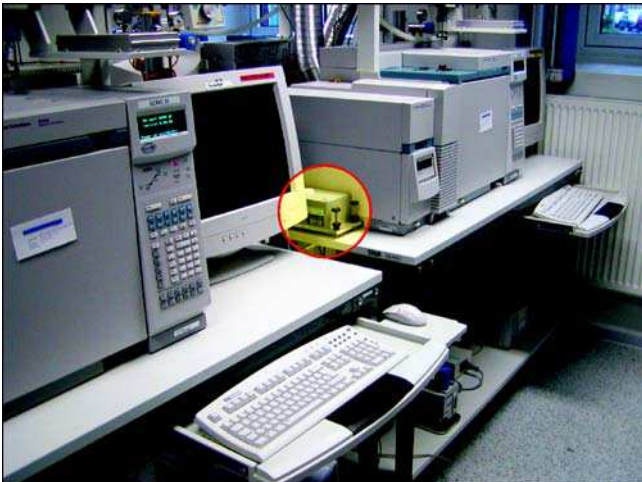
Bild 3.18: Schwingungsmessungen an hoch empfindlichen Forschungsanlagen
