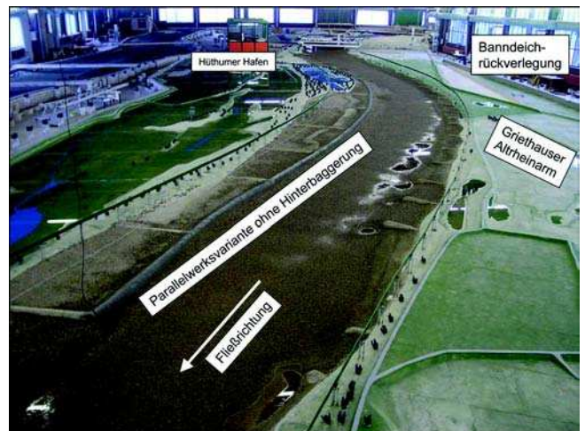
Bild 4.5: Blick von Unterstrom in das physikalische Modell Emmerich; im Hintergrund ist der zurückgebaute Zustand der Banndeichrückverlegung erkennbar. Im Vordergrund ist eine Parallelwerksvariante entlang der Buhnenköpfe vor dem Vorland Emmericher Ward zu sehen
