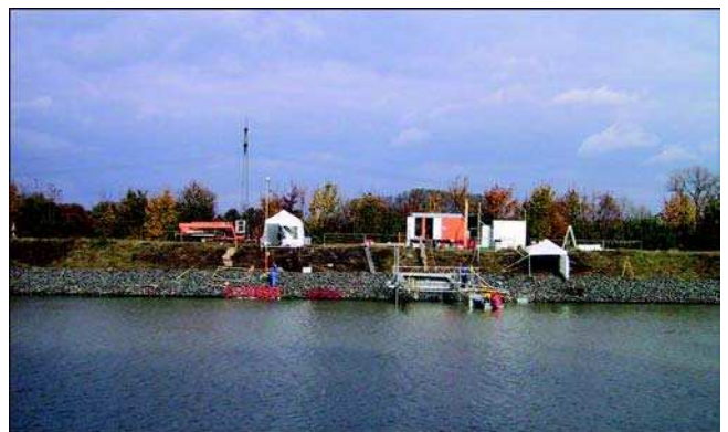
Bild 4.18: Überblick der Messeinrichtungen am Wesel-Datteln-Kanal; von links nach rechts: Hubsteiger zur Videobeobachtung, Versuchsfelder Deckwerk mit Videoaufnahmen von Teleskopmast, Gerüst mit Geräten zur Wellenhöhenmessung
