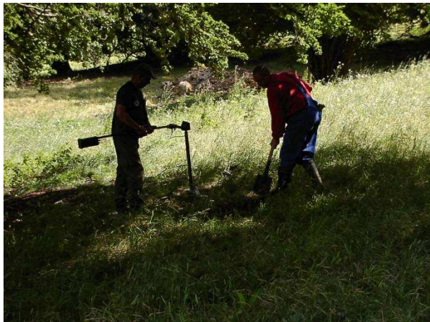
Bild 3: Einsatz eines Gradiometers bei der Bergung von Munition Quelle: Schollenberger 2011
