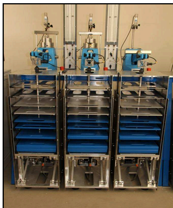
Bild 25: automatisierter KD-Stand des bodenmechanischen Labors der BAW-Hamburg
