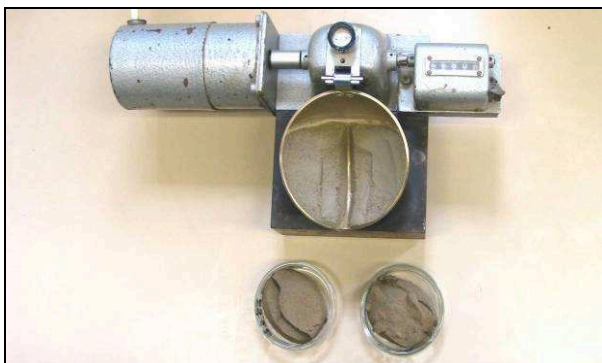
Bild 7: Fließgrenzengerät nach Casagrande
