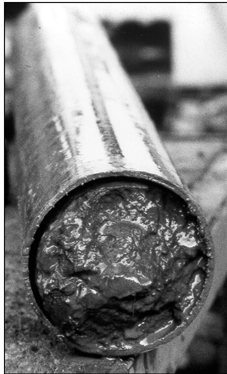
Bild 30: Rammkern mit Ringraum
