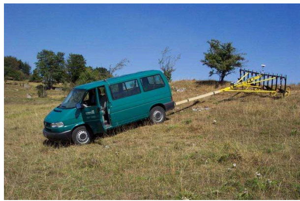
Bild 5: GPS gesteuertes Sondenarray im Einsatz Quelle Schollenberger 2011
