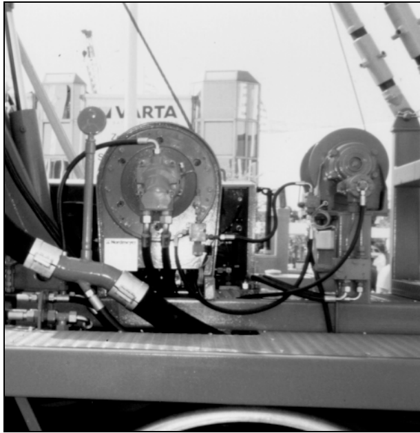
Bild 9: Seilwinde und Hilfswinde
