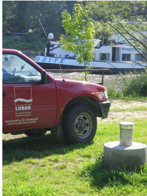
Bild 2: Grundwasser-Messstelle in der Talaue einer Bundeswasserstraße
