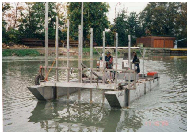
Bild 6: GPS gesteuertes Messboot im Einsatz Quelle Hirdes 2011
