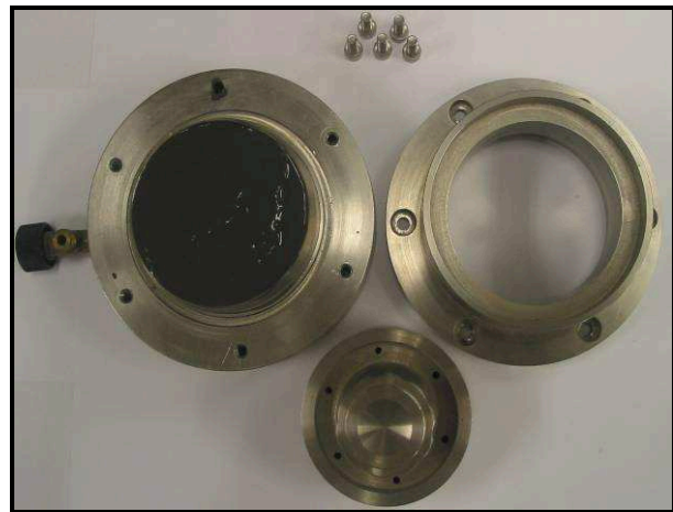
Bild 24: Oedometerzelle des bodenmechanischen Labors der BAW Hamburg
