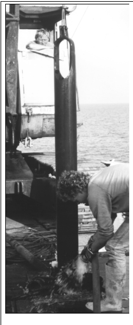
Bild 17: Ventilbohrer unter Wasserzugabe ziehen
