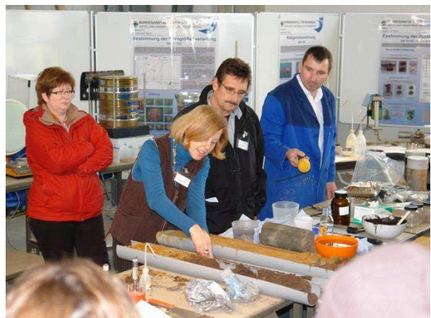
Bild 1: Bearbeitung eines geöffneten Kernliners (BAW-Baugrundkolloquium 2008)
