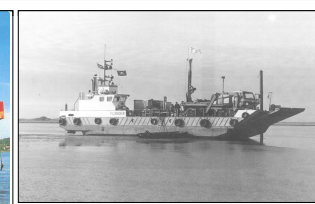
Bild 3: Drucksondierungen auf dem Wasser
