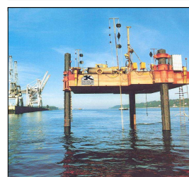
Bild 3: Drucksondierungen auf dem Wasser
