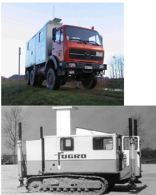
Bild 2: Sondiergeräte für Drucksondierungen an Land
