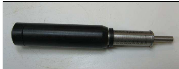
Bild 10: Taschenpenetrometer mit Skalierung
