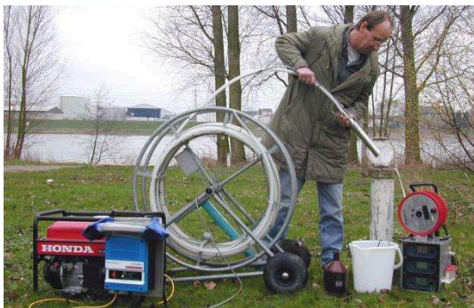
Bild 2: Qualifizierte Grundwasser-Probenahme mittels Unterwassermotorpumpe (U-Pumpe)
