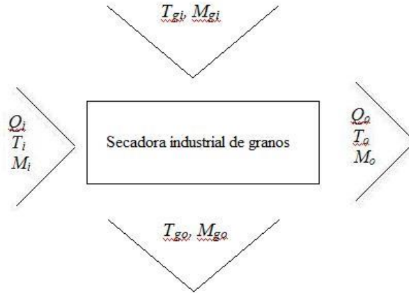
Figura 2 – Esquema básico de una secadora industrial de granos. Q_i , T_i y M_i son el caudal, la temperatura y la humedad del aire de entrada. Q_o , T_o , y M_o , son los del aire de salida. T_{gi} , M_{gi} y T_{go} y M_{go} son las temperaturas y humedades de los granos a la entrada y a la salida de la secadora. (Elaboración propia)
