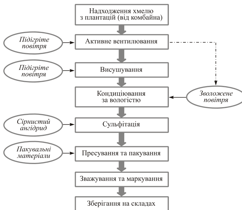
Рис. 3.1. Принципова технологічна схема післязбирального оброблення хмелю
