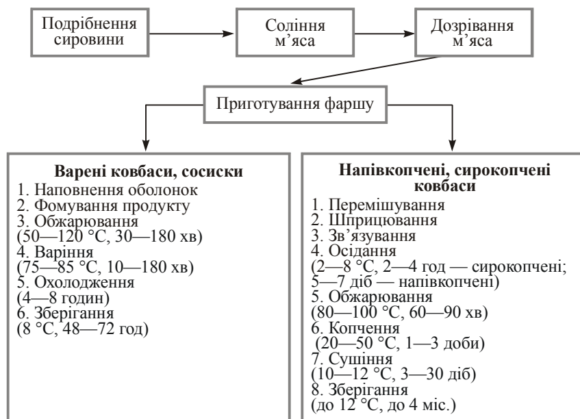
Рис. 7.2. Принципова схема технологічних операцій у виробництві ковбасних виробів
