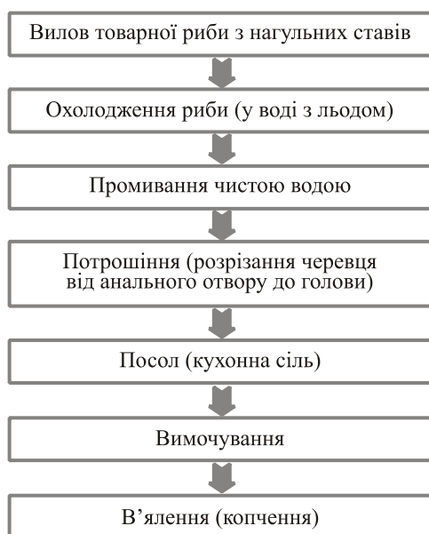
Рис. 8.1. Принципова схема технології первинної переробки риби, виловленої з прісних водойм
