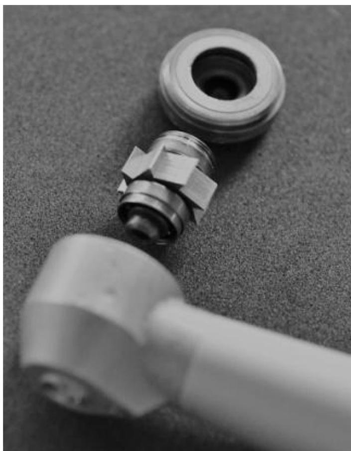
Interior del Cabezal de una Turbina
