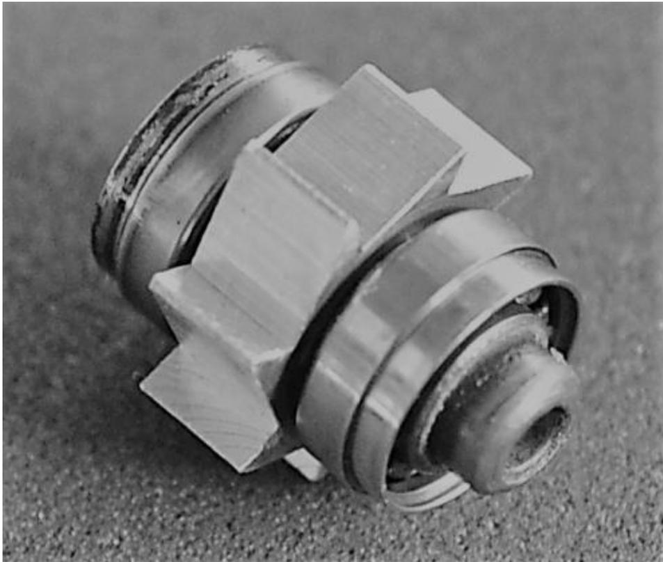
Rotor de una Turbina
